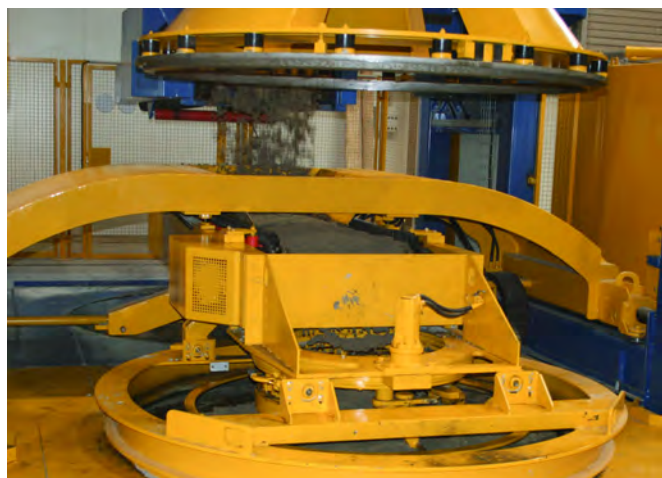
Сооружена новая система снабжения бетоном установки Magic 2500, на фотографии – быстрая загрузка бетона в машину
