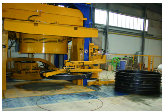
Устройство автоматической подачи опорной муфты-поддона является важным элементом обслуживания установки
