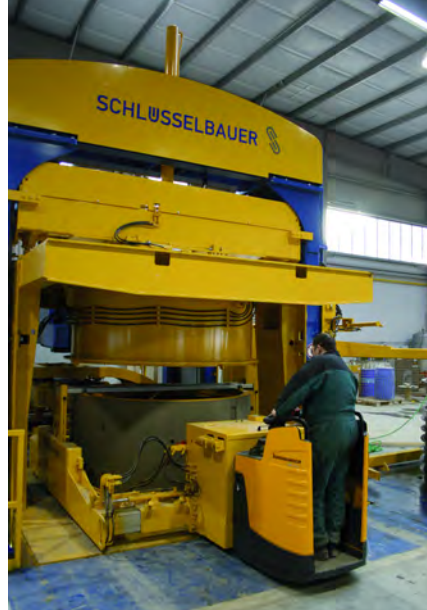
Манипулятор позволяет оператору без посторонней помощи легко размещать муфты на изделия
