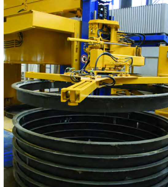
Инновация в постановке муфт-поддонов: манипулятор принимает на себя трудоемкий процесс установки
