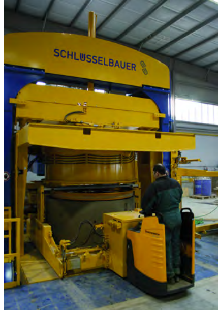
Для транспортировки продукции используется электрокар с манипулятором для установки защитных муфт
