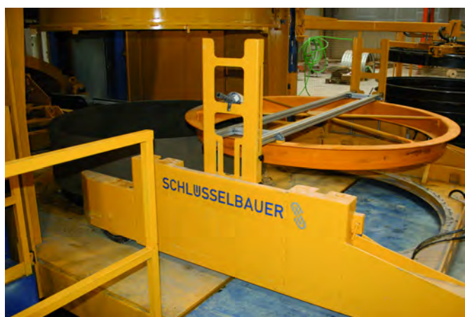
Автоматизированные процессы позволяют одному человеку обслуживать всю промышленную установку, вручную выполняется только закладка арматурного каркаса
