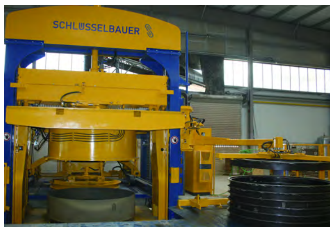
Промышленная установка Magic 2500 для производства изделий с внешним диаметром до 2700 мм
